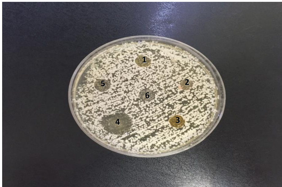
Figura 18. Resultado da avaliação da atividade biológica de discos dos filmes poliméricos CMC/PVA (20%) (1), CMC/PVA (2), CMC/PVA (30%) (3), CMC (4), CMC (20%) (5), e CMC (30%) (6) contra C. albicans ATCC 76485, método de difusão em meio sólido-disco.
