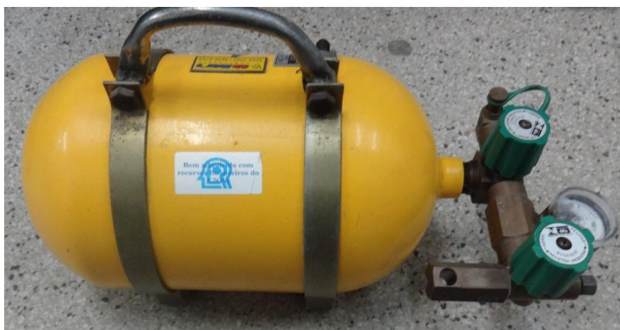
Figura 3.2 - Fotografia do cilindro utilizado como amostrador adaptado para manuseio do GNV, este suporta pressão de até 500 bar.
