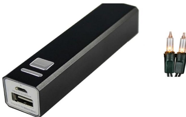
Figura 15 – Carregador portátil para celular com alimentação das lâmpadas incandescentes usadas como fonte de radiação. Em detalhe, uma foto do tipo de lâmpada usada.
