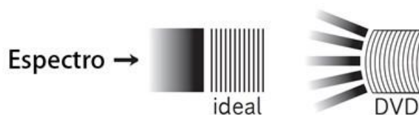
Figura 18 – Espectro ideal, gerado com grade de difração comercial e o espectro gerado pelo fragmento de DVD.
