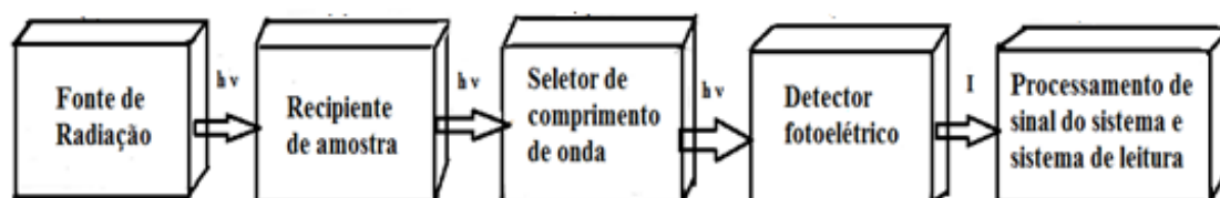
Figura 4 – Componentes básicos de um instrumento para espectrometria de absorção. Esse diagrama esquemático é referente aos instrumentos multicanais, como por exemplo, instrumentos com arranjo de fotodiodos. Adaptado [38] .
